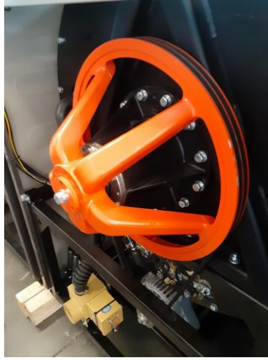
アルミ合金製プーリーを採用、アルミの軽量さで主軸に負荷かけず、メンテナンスフリーに寄与
