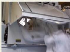
特殊な内胴形状と傾斜させてから後扉を開く排出方法で絡みなく排出させます。主に、シーキング目的の乾燥機のオプションとして。
