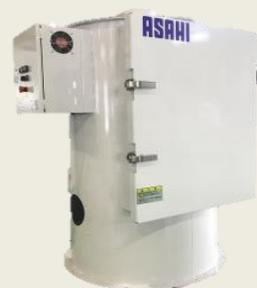
複数台の乾燥機より、自動リント除去機能により落としたリントは、1台のTAL-1に回収されます。**掃除個所が1か所**になり、生産終了後の残業時間削減。
