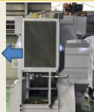
ヒーターを側面取付にすることで、フィルター清掃を容易にしました。また、鉄製縦ワンパスヒータ採用で**耐久性UP**しました。
